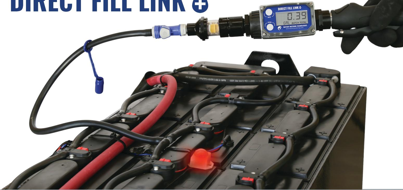
Según la calidad del agua, el sistema de llenado directo Plus puede conectarse a una manguera de jardín estándar, un desionizador o un carrito Aqua Sub™ para poner el agua directamente en las baterías. El sistema de llenado directo Plus lleva un indicador de flujo incorporado y un regulador de presión que reduce la presión hasta 10 PSI. Puede manejar hasta 90 PSI de la fuente de agua.
